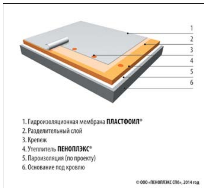
Рис. 1. Механическая кровля с материалом ПЛАСТФОИЛ®
