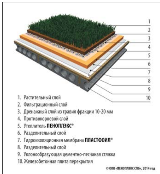
Рис. 3. Инверсионная кровля с материалом ПЛАСТФОИЛ®
